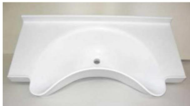
Die ergonomische Beckeneinbuchtung erlaubt die komplette Annäherung an den Waschtisch. Dabei schützen die hochgezogene Frontschürze und der Schwallrand an den geraden Frontbereichen vor Spritzwasser bzw. überschwappendem Wasser. Der OP-Waschtisch wird aus einem Stück nach Maß gegossen und entspricht der CE-Kennzeichnung nach DIN EN 14688.
